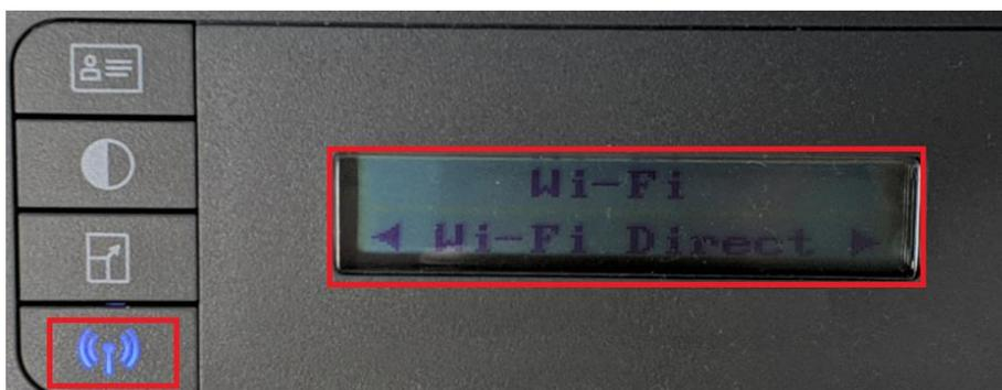
2 在无线直连菜单 (**Wi-Fi Direct**) 中找到**开/关**，确认无线直连功能**打开**后找到 **Network 密**
